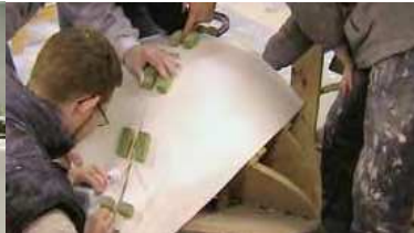
Aplicación del adhesivo DuPont™ Corian® en juntas
